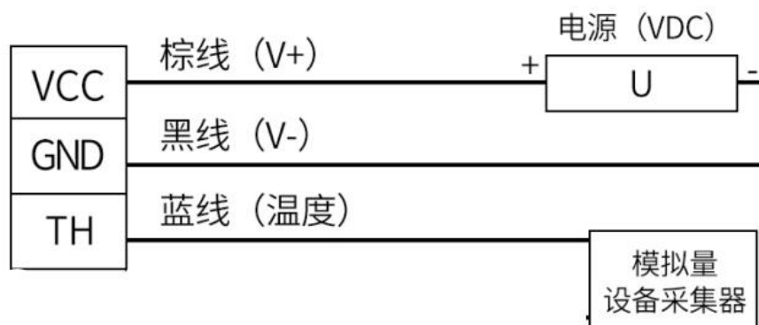
模拟量接线示意图
