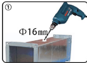
① 在非风管上打一个直径16mm的孔
