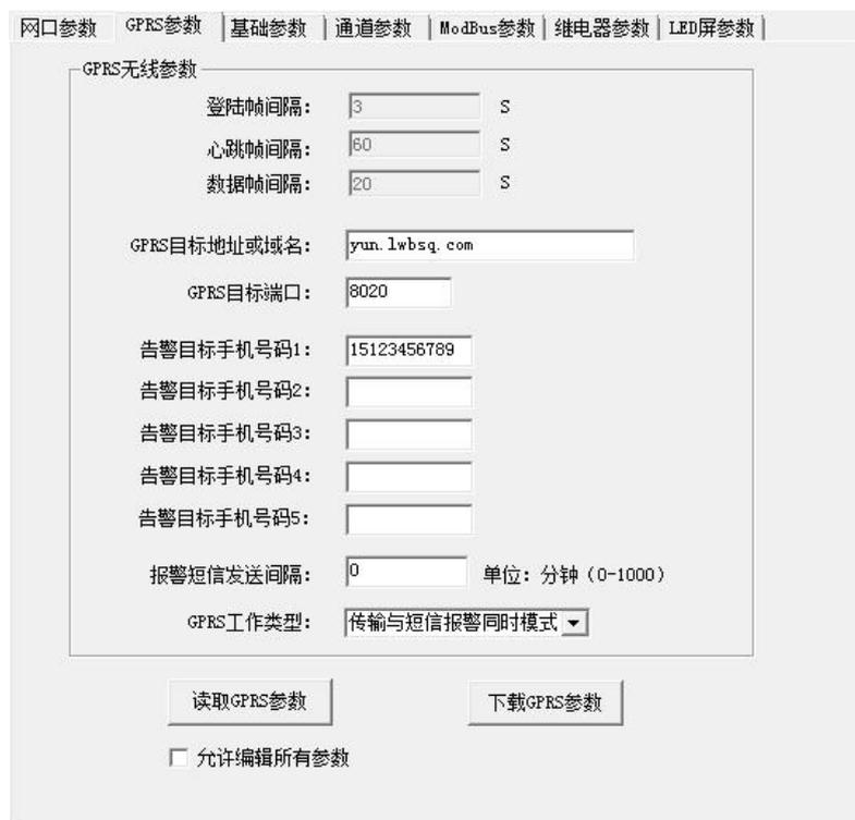
选择 GPRS 参数选项卡，单击“读取 GPRS 参数”按钮，可将参数读取到软件界面，用户可以修改参数，单击“下载 GPRS 参数”可将参数下载到设备中。
