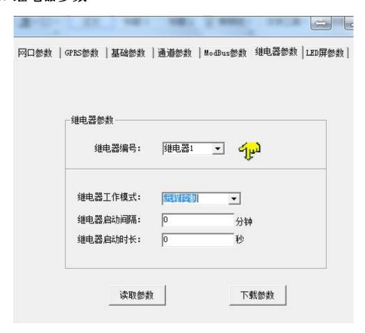
继电器参数标签页主要设置监控主机继电器的工作模式。监控主机自带两路继电器,编号分别是继电器 1 和继电器 2。
