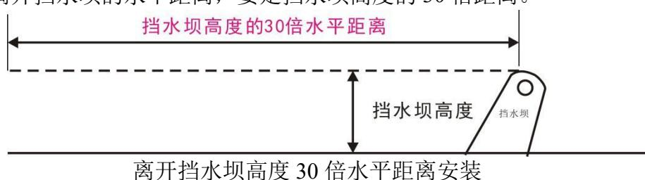
3. 因为底层水流速缓慢，安装的时候也可以安装在挡水坝顶部 5-10 厘米处，
