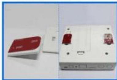
1. 将壁挂扣安置在壁挂孔上
