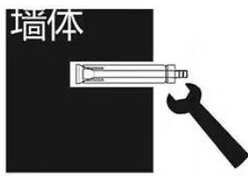
2 将膨胀螺栓打入洞中后，依次取下螺母，弹垫，平垫，设备安装孔穿过已经安置好的膨胀螺栓，依次放置平垫，弹垫，螺母，最后用扳手拧紧螺母
