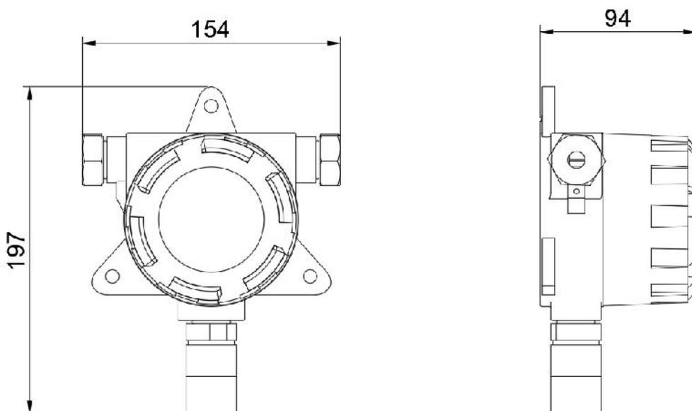
无源继电器跟不带声光报警器壳体尺寸图 (单位: mm)
