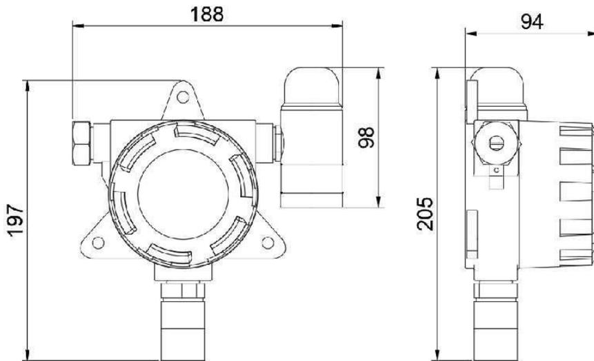
带声光报警器壳体尺寸图 (单位: mm)
