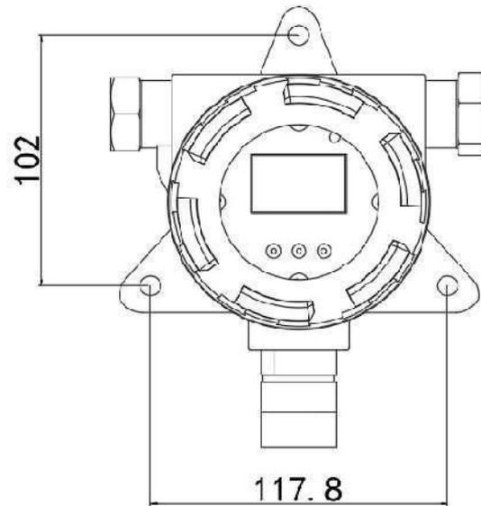
膨胀螺丝安装时，先在墙体或其它固定平面打孔，将膨胀塞放入孔内，拧入螺丝帽使膨胀塞膨胀，然后卸下螺丝帽安装设备，最后拧入螺丝帽将设备固定。
