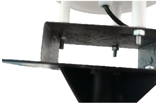
固定一体式气象站的螺丝孔位置
