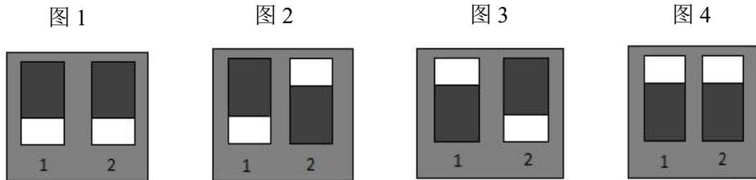
图 1 所示：拨码开关对应量程 0~20m/s
