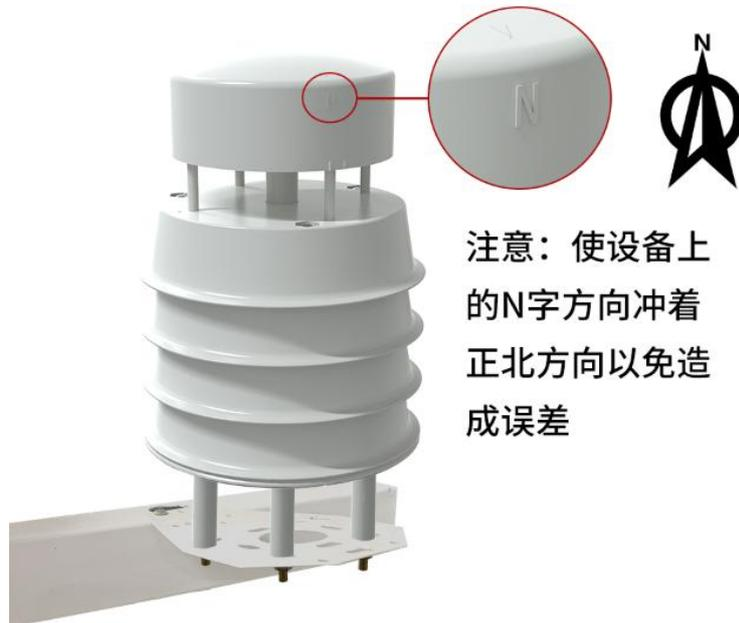
注意：使设备上的N字方向冲着正北方向以免造成误差
