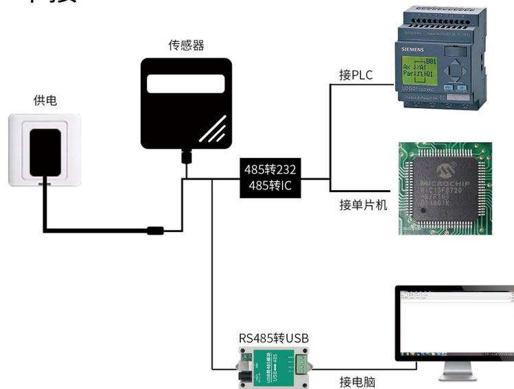
本产品也可以多个传感器组合在一条 485 总线使用，理论上一条总线可以接 254 个 485 传感器，另一端接入带有 485 接口的 PLC、通过 485 接口芯片连接单片机，或者使用 USB 转 485 即可与电脑连接，使用我公司提供的传感器配置工具进行配置和测试（在使用该配置软件时只能接一台设备）。
