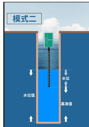
$$\text{水位值} = \text{水位} + \text{基准值}$$
