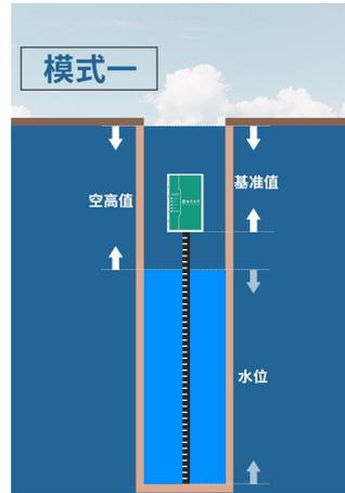
$$\text{空高值} = \text{水尺总长} - \text{水位} + \text{基准值}$$
