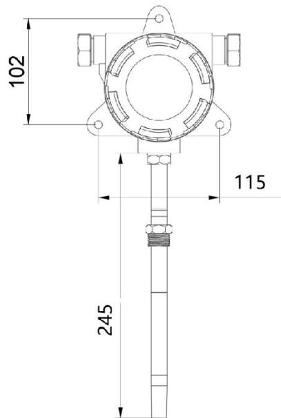
膨胀螺丝安装时，先在墙体或其它固定平面打孔，将膨胀塞放入孔内，拧入螺丝帽使膨胀塞膨胀，然后卸下螺丝帽安装设备，最后拧入螺丝帽将设备固定。
