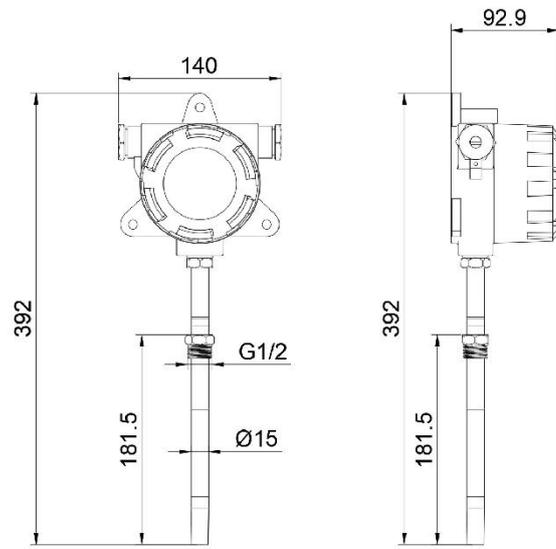
带显示壳体尺寸图 (单位: mm)
