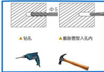
1. 在墙壁上使用钻头打入直径为5的两个圆孔，间隔距离95mm，然后将膨胀螺栓放入圆孔中
